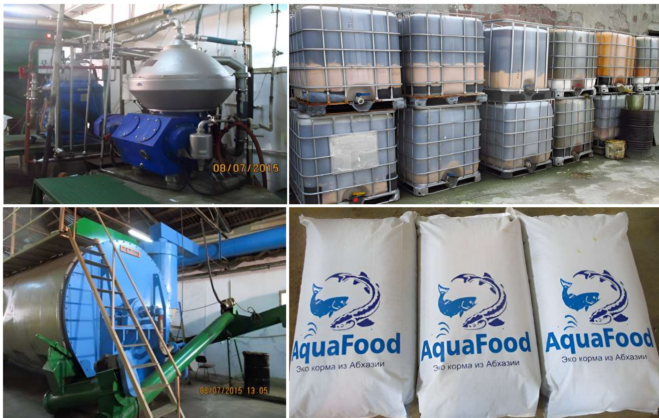
Рис. 1. Установки для переработки хамсы в рыбную муку, рыбий жир и гранулированные рыбные корма марки AquaFood производства Абхазии
